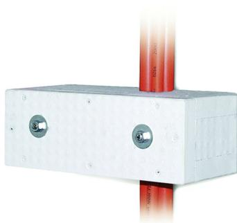
Эффективный способ закрепления кабеля при вертикальном монтаже, использовать на интервалах до 3,5м с профилем DR15.30 и кабельным зажимом HDH1. Соответствует стандарту огнестойкости DIN4102-12.
